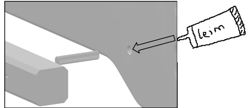
Befestigen Sie die mitgelieferte Auflagerleisten jeweils mittels 3 Dübel (Pos. 4) und 4 Spax (Pos.5) am Längsteil Ihres Bettes
