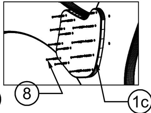
1. Bauen Sie zuerst Ihre Seitenwängenteile (Pos. 1a und Pos. 1b) mittels der Verbindungsplatte (Pos. 1c) zusammen. Um eine passgenaue Verbindung zu gewährleisten drücken Sie die Dübel (Pos. 9) mit etwas Holzleim in die dafür vorgesehenen Bohrlöcher. Legen Sie die Verbindungsplatte (Pos. 1c) wie abgebildet auf Ihre Wange und schrauben diese mittels der 5x50 Edelstahlschrauben ( Pos. 8) fest.
