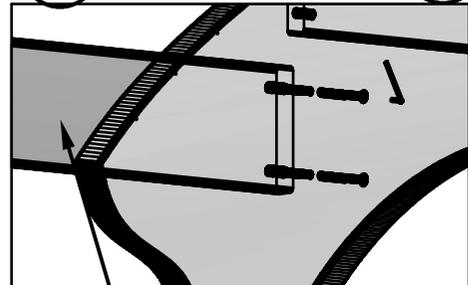
2. Verbinden Sie die Seitenwangen (Pos. 1) mit den Stellbrettern (Pos. 2) mittels der M8x60 Senkkopfschrauben (Pos. 4) mit Hilfe des im Lieferumfang enthaltenen Inbusschlüssels.
